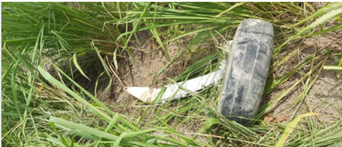
Fotografía No. 4: Desprendimiento tren de aterrizaje LH HK-1997
